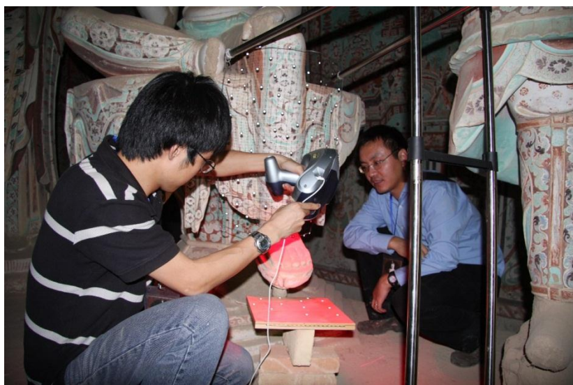
毕业生参加“敦煌莫高窟数字化保护项目”，用手持式扫描仪采集文物三维数据
